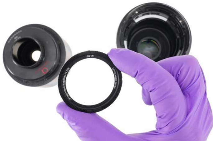
内部光学ガラスを取り出した状態
