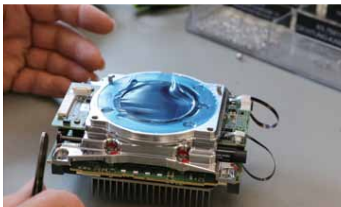
覆盖着塑料膜的影像传感器安装在电路板上
