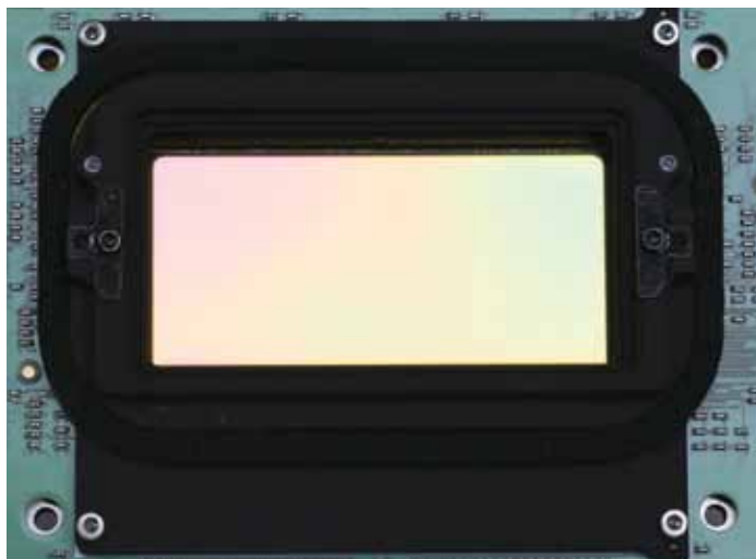
ALEXA 65影像传感器——实际尺寸：54.12 x 25.59 mm (6560 x 3102)
