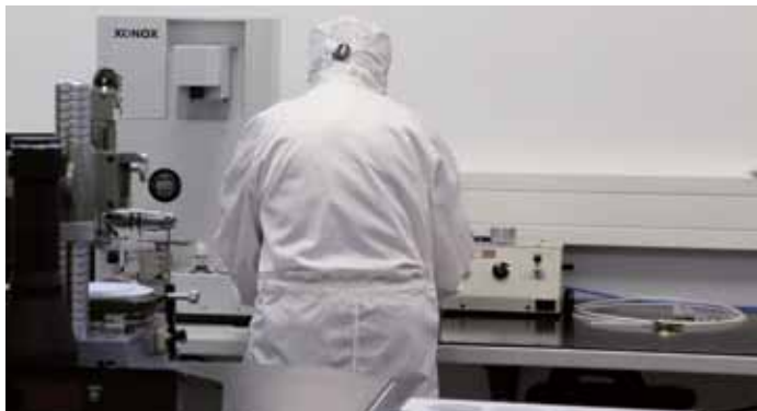
无尘室内组装光学元件
