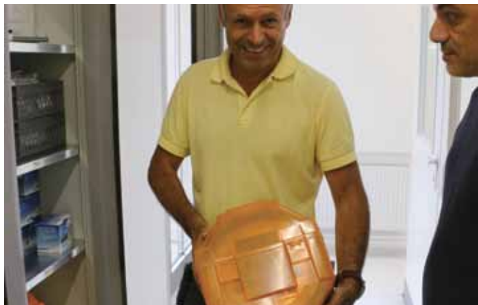
影像传感器焊接和无尘室装配负责人齐格弗里德·韦茨切克 (Siegfried Wetscheck) 展示装在气密封胶盒里送来的影像传感器晶元
