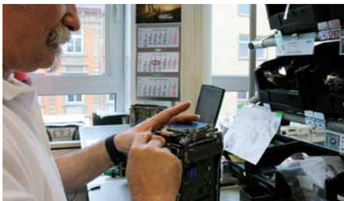
一件式流水线制造：摄影机经过各个工作站时，每一位装配技师给摄影机安装上相应部件。
