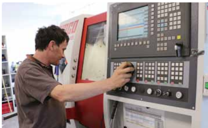
生产机械零件的数控机床
