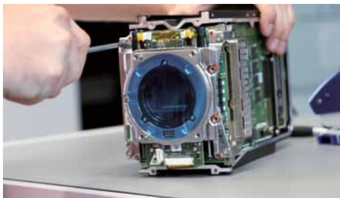
将影像传感器组件装配到内部骨架和电路板上
