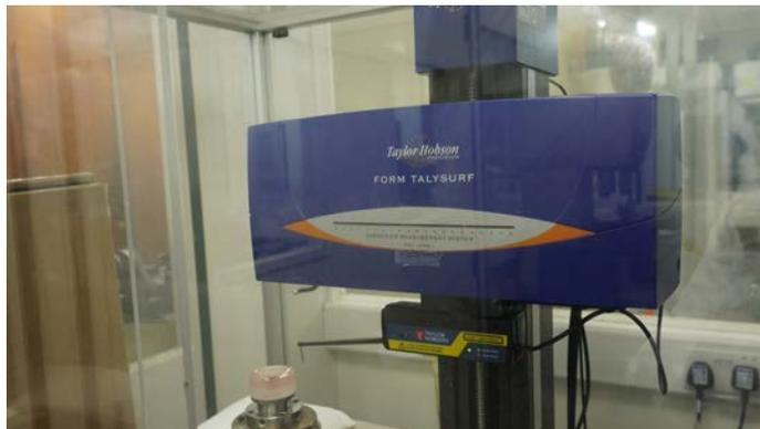
Form Talysurf 表面轮廓仪可以测量球面抛光的波动。最初泰勒·霍布森的Talysurf在1941年诞生，可以准确测量表面材质。
