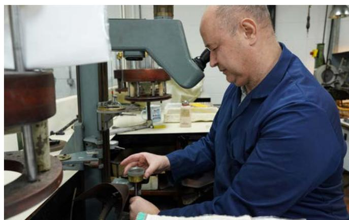
从准直仪观测并将镜片对准中心,趁着沥青还热乎。
