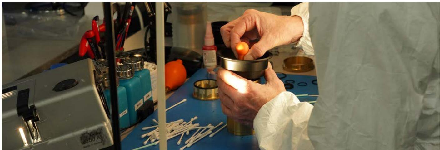
上图:之前的修边工作在镜片安装到镜筒中时终于派上了用场。下图:在一个流水线工作站里,凸轮与凸轮跟焦环配对。
