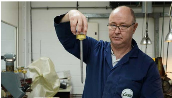
修边可以让镜片顺利放入镜筒内的金属支架。保罗·乌廷展示：一旦冷却，沥青就粘得像胶。
