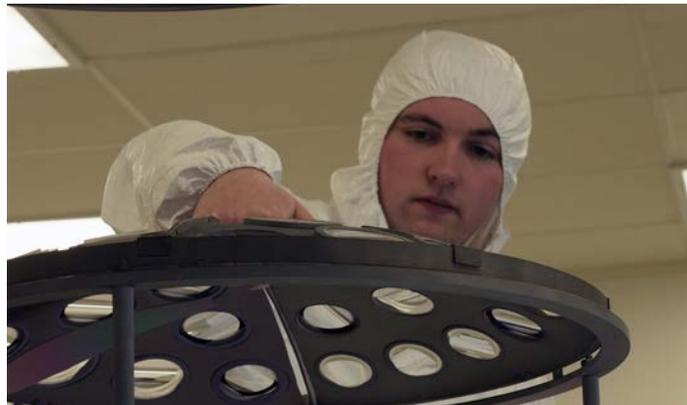
我的名字是伊恩·约翰逊, 我是一名镀膜师。我已经在公司工作35年了。我们使用不同的机械完成工作: Bühler、Belzer和Leybold。镀膜的过程是在高温真空中使用矿物质蒸汽在玻璃上形成薄薄的膜。
