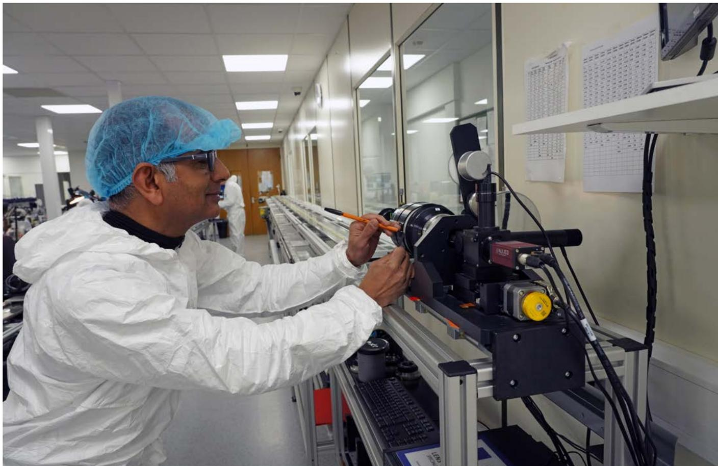
拉杰·米斯特里正在手动校准每支镜头的对焦刻度。之后，对焦筒将会用激光雕刻。
