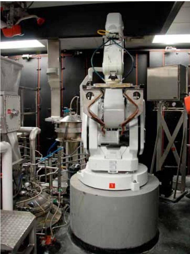
Los robots evitan la variabilidad: manipulan, mezclan y vierten los ingredientes para las capas.
