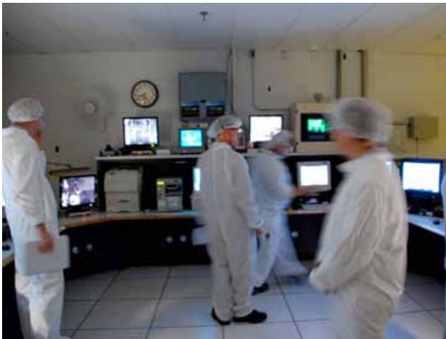
Sala de control FAM (Finished Advanced Melt – Terminación de Mezclado Avanzado) , donde el proceso de fabricación de las capas base es monitoreado.
