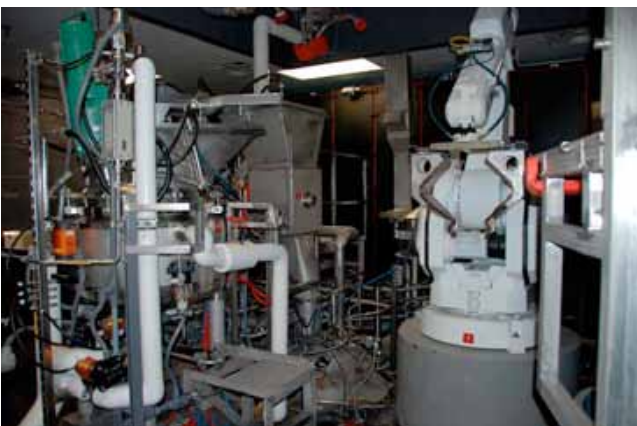
Los robots evitan la variabilidad: manipulan, mezclan y vierten los ingredientes para las capas.
