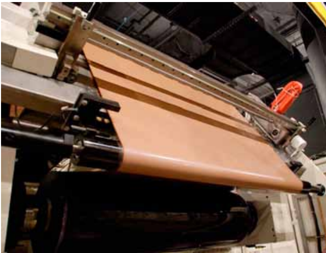
Los 6.000 pies de rollo master son retirados de los contenedores (en la oscuridad) y preparados para el corte
