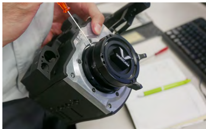
É possível a montagem de outras lentes, por exemplo a Panavision PV.
