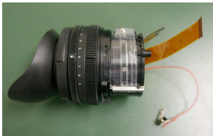
O ajuste de dioptria tem "click stops", bom por prevenir deslocamento acidental.
