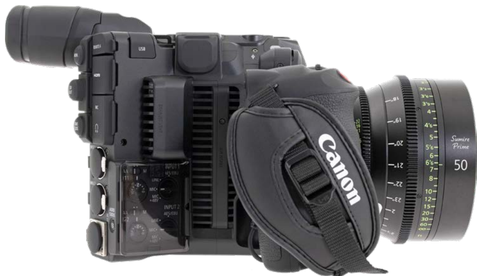
カメラ右側: C500 Mark II、 ハンドグリップGR-V1、EVF-V50、 スミレプライムレンズ50mm
