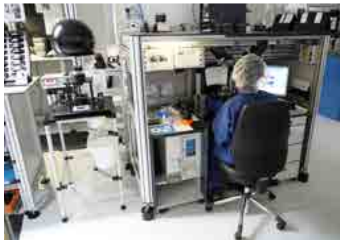
3つの空間周波数を同時に測定できるツァイス製K8 MTF検査機(右)とTストップ検査機(左) これらは世界中のツァイス認定サービスセンターで使用されているのと同じものである。
