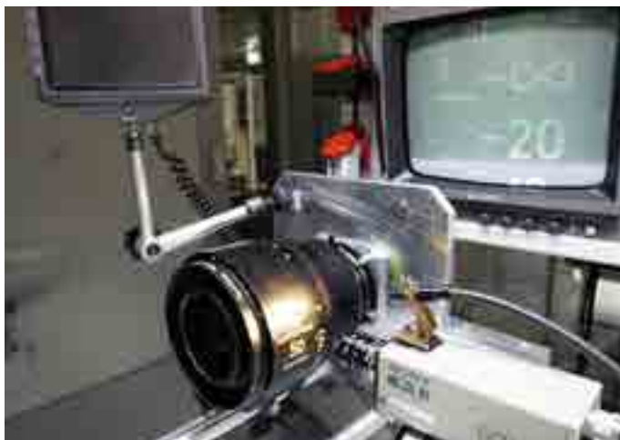
出荷前のマスタープライム50mmが検査され、各数値が社内データベースに保管されているところ。こうしたデータはのちに、修理が必要になった際に活かされる。
