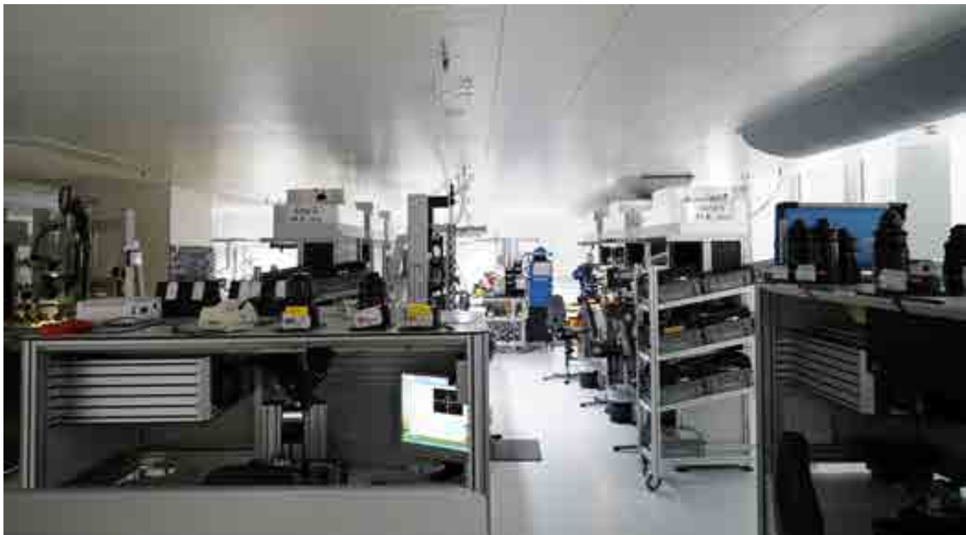
(写真上) ARRI/ZEISSレンズの組み立てライン。はじめに鏡筒を組み立て、その中にレンズユニットが収められる。 次にK8 MTF検査機を使ってレンズ位置を調整し、フォーカス環を取り付け、再度検査が行われる。
