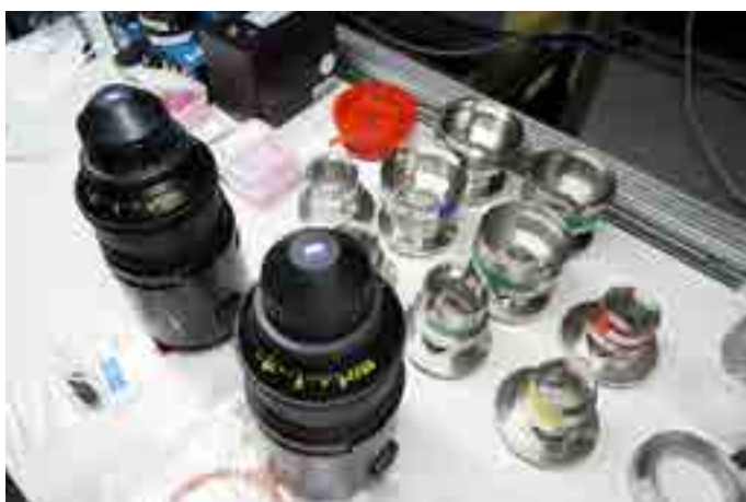
マスターアナモフィック135mmの鏡筒内にレンズユニットを収めるための特殊な工具類
