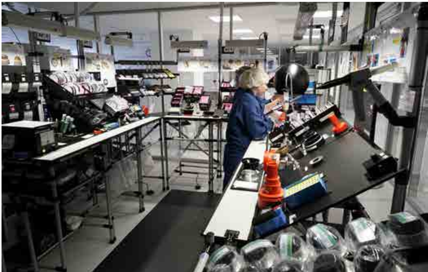
U字型に配置されたレンズ組み立てステーション、作業効率を重視して工具と部品は作業者から25cm以内に置かれており、またこのため作業テーブルにも傾斜が付けられている。
