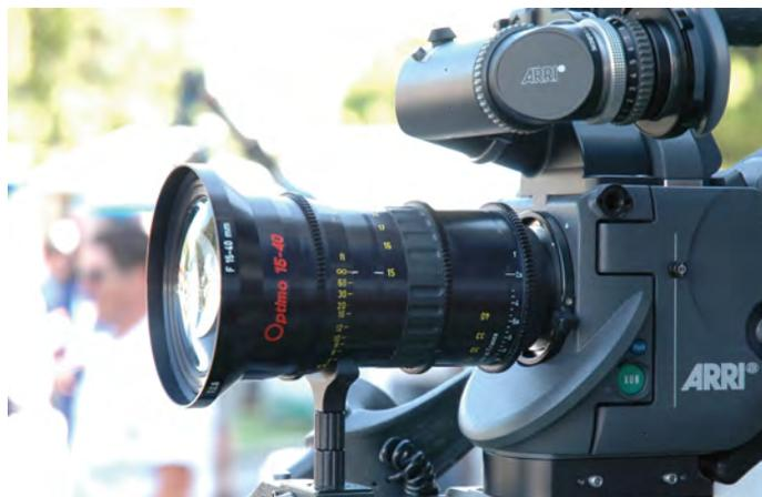
**2006年、** アンジェニューは、シリーズ最初の軽量、手持ち用ズームレンズ、15 - 40mm T2.6 Optimo を発売。この明るさ T2.6 の2.7倍ズームは重さが2Kgと軽く、大きな技術的成果を現していた。肩担ぎ、手持ち、ステディカムカメラ用の設計。
