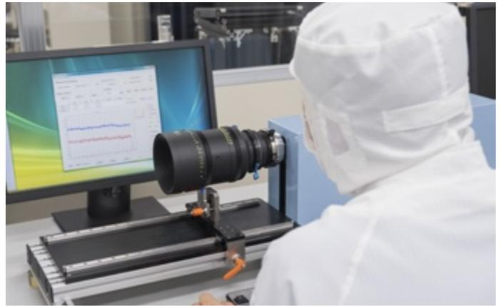
测量扭矩(镜筒的阻尼), 确保操作顺滑。
